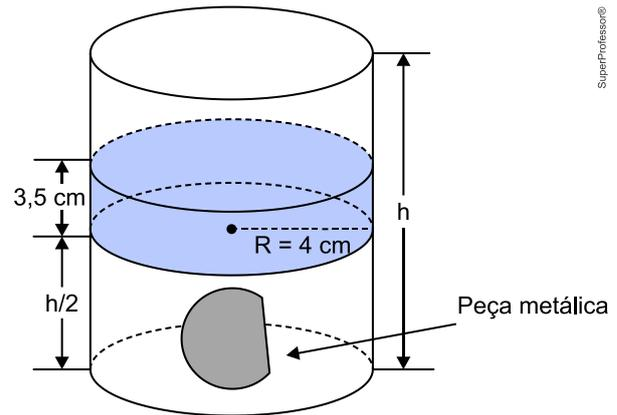
O volume da peça metálica é igual ao volume de água deslocada (destacado na figura).
